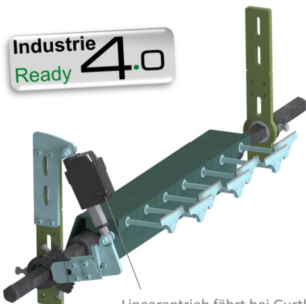
Linearantrieb fährt bei Gurtlauf richtungswechsel aus bzw. ein
